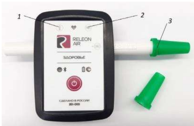
Рис. 3. Мультидатчик по физиологии. Обозначение разъёмов и технологических отверстий: 1 — температура тела, 2 — пульс, 3 — частота дыхания (надет съёмный мундштук)
