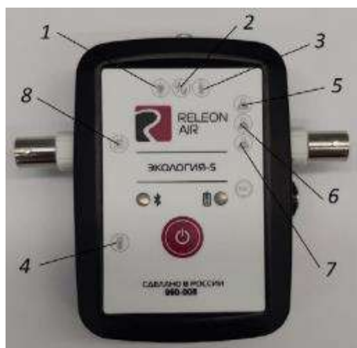
Рис. 2. Мультидатчик по экологии. Обозначение разъёмов и технологических отверстий:
